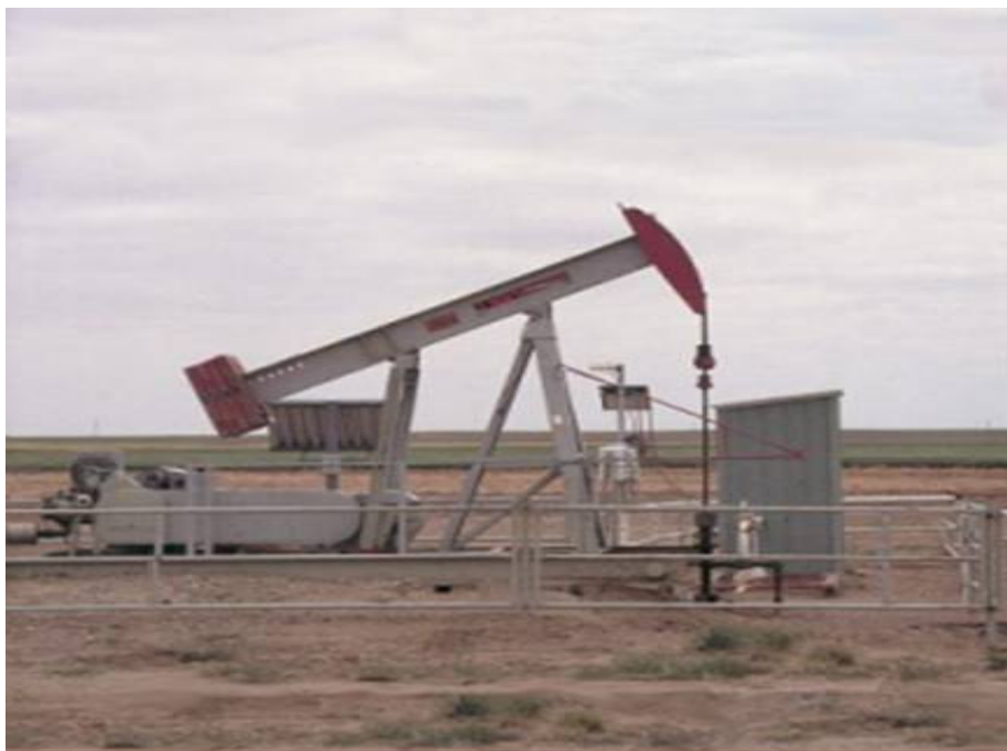
Figura 7 - Bomba para Produção de Petróleo Onshore
