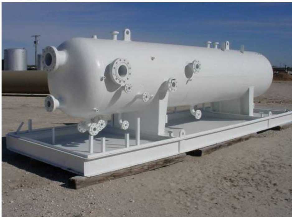
Figura 9 - Facilidade para Separação de Hidrocarbonetos FONTE: DEVOLD, 2006
