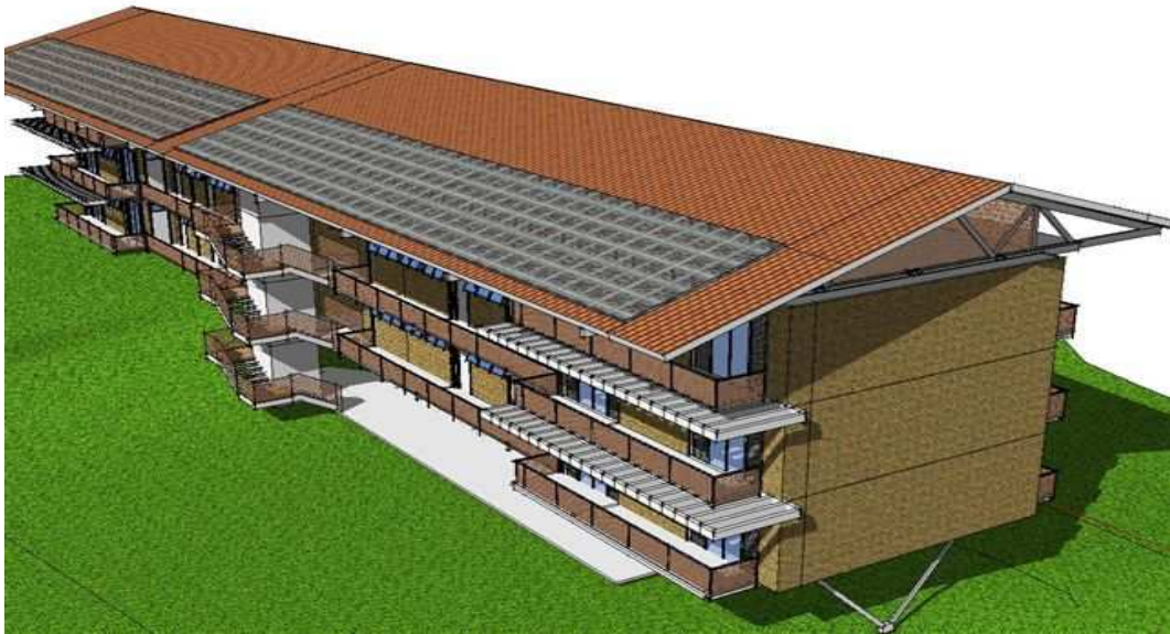
Figura 53 - Placas solares nos edifícios residenciais.
