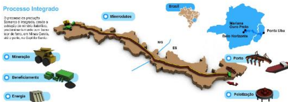
Figura 11 - Processo integrado da produção de pelotas de minério de ferro.
