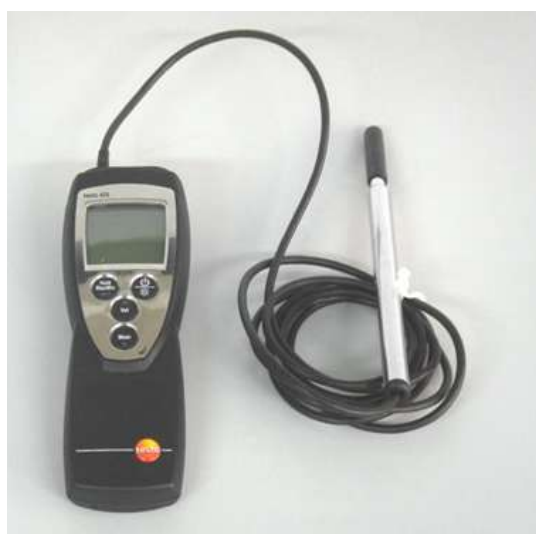
Figura 39. Termo-Anemômetro modelo 425, fabricado por Testo do Brasil LTDA.
