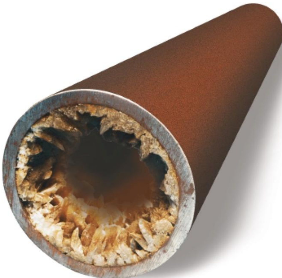
Figura 1.3. Incrustação de carbonato de cálcio em uma coluna de produção.
