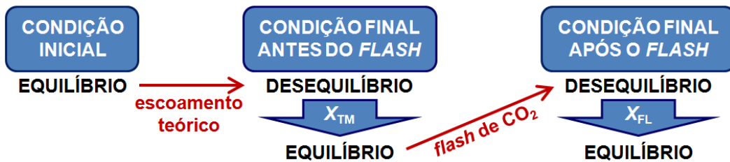
Figura 3.2. Fluxograma para a simulação da massa de calcita precipitada.
