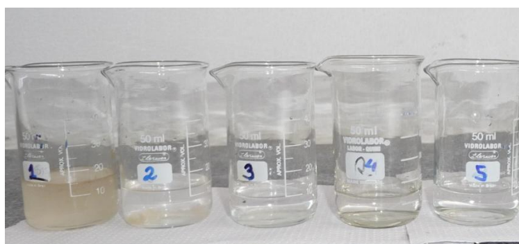
Figura 5.5 – Aspecto visual do efluente bruto (1) e após o tratamento com eletrofloculação no tempo de eletrólise de (2) 5 minutos, (3) 10 minutos, (4), 20 minutos e (5) 30 minutos.
