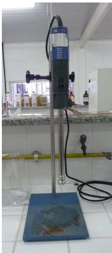
Figura 4.1 – Agitador modelo T18 basic ULTRA-TURRAX ® .
