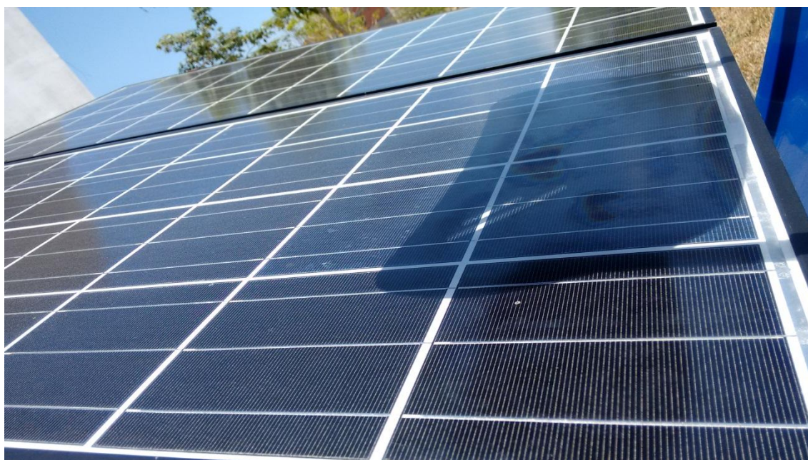
Figura 33 - Testes em módulo fotovoltaico com duas células sombreadas, afetando os dois arranjos série (sombreamento difuso)
