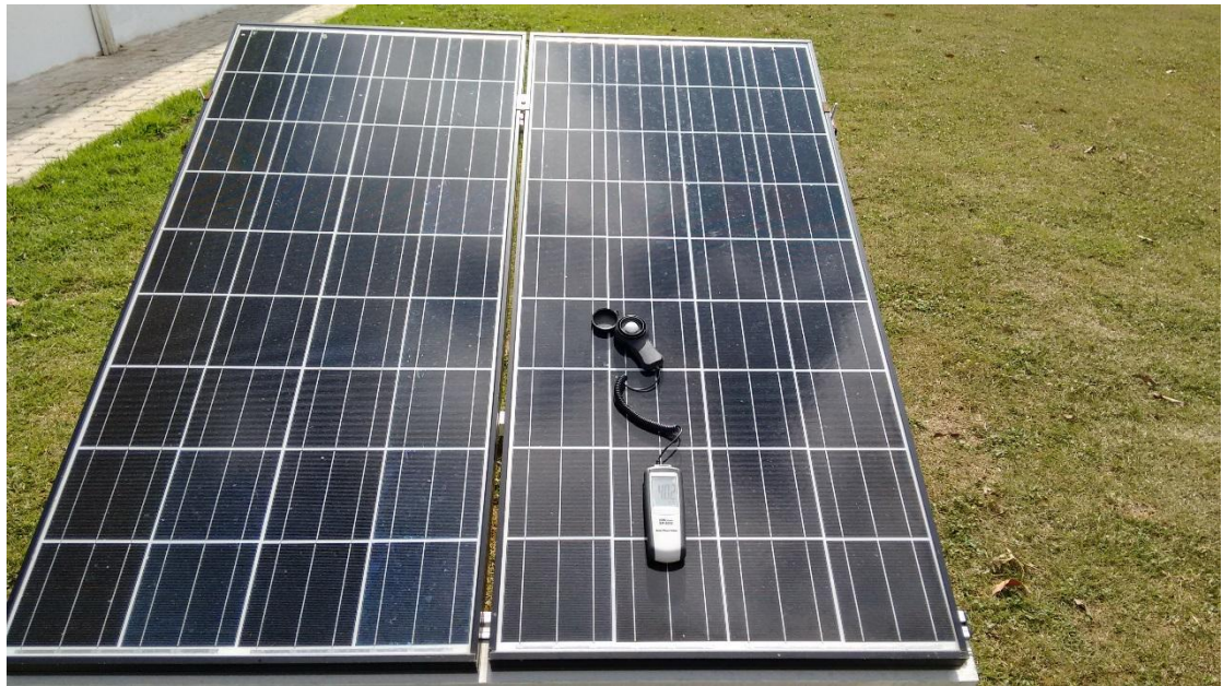
Figura 36 - Medição da irradiância durante os testes
