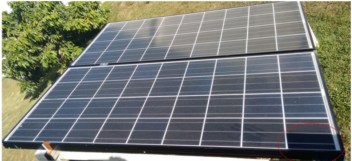
Figura 35 - Testes em módulo fotovoltaico com sombreamento parcial
