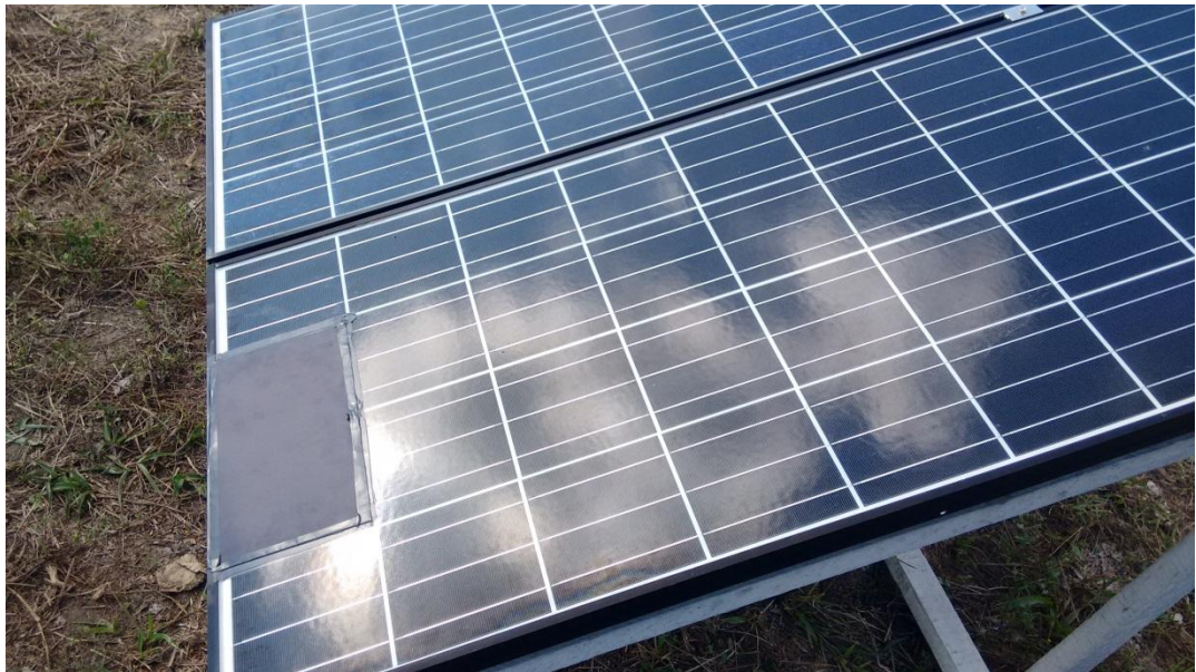
Figura 34 - Testes em módulo fotovoltaico com duas células sombreadas, afetando os dois arranjos série (sombreamento opaco)
