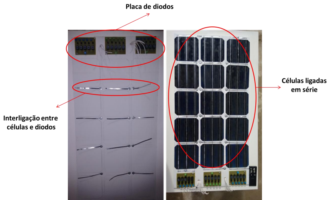
Figura 37 - Montagem do Painel Fotovoltaico
