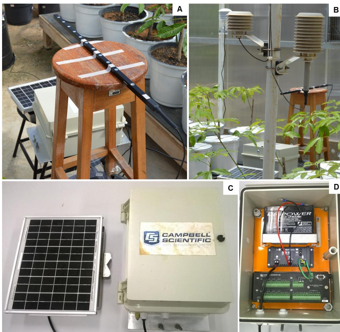
Figura 2 – Sensores SQ-311 radiômetro PAR quântico com 10 sensores da marca Apogee (A), CS500 de temperatura e umidade da marca Vaisala (B) e datalogger Campbell Scientific CR-10X (C e D), utilizados para controle do microclima estabelecido em casa de vegetação, durante o período experimental de 167 dias, no município de Jerônimo Monteiro, ES.
