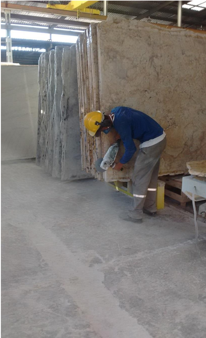
Fotografia 3: Remoção de resina na parte (de trás) inferior da chapa.
