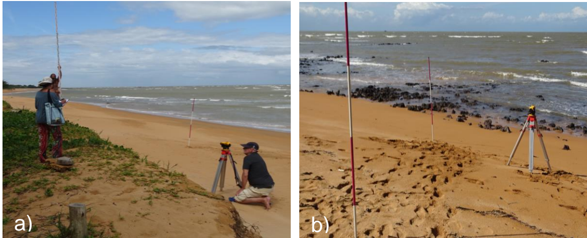
Figura 4.3 - (a) Levantamento topográfico do perfil praiado emerso e (b) da porção das plataformas de abrasão emersa durante a baixa-mar, por meio de nível de precisão, mira graduada e trena. Fotos: setembro, 2015.
