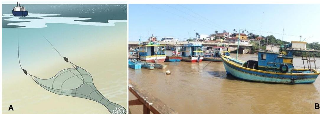
Figura 2 – (A) Esquema da embarcação modelo saveiro médio equipado com uma rede de arrasto do tipo “otter trawl”. Disponível em: <<http://explow.com/trawling>>. (B) Foto de embarcação do tipo saveiro utilizada na pesca artesanal de arrasto do litoral sul do Espírito Santo (Arquivo pessoal).
