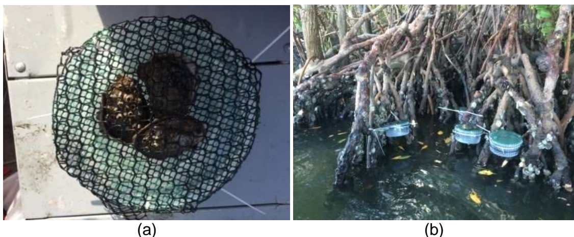
Figura 32: Experimentos in situ da TC de C. rhizophorae : a) coletores de biodepósitos com 3 espécimes de ostras e b) coletores fixados nas raízes de Rhizophora mangle na maré baixa.
