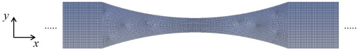
Fig. 6. Detalhe da discretização do domínio contínuo na constrição do microcanal 2D.
