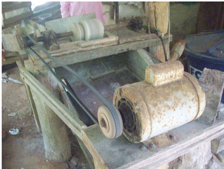
Fotografia 4 – Motor e rodete do quitungo (casa de fabricação de farinha) de Pedro Pereira Barcelos. É nessa máquina que a mandioca é processada para a produção da massa da raiz, que é posteriormente prensada e torrada, transformando-se na farinha. Foto do autor (19/02/2016).
