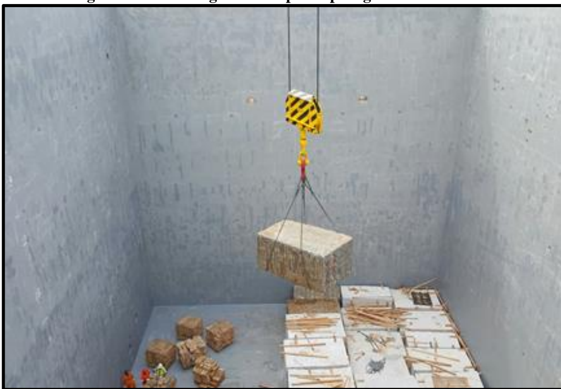
Figura 5 - Bloco de granito suspenso pelo guindaste de bordo
