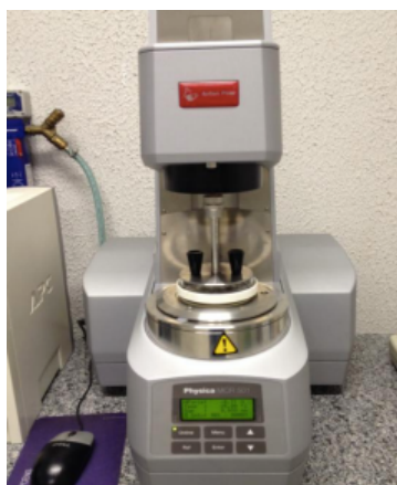
Figura 13. Reômetro Physica MCR 501 da Anton Paar.
