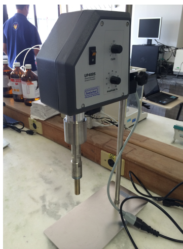
Figura 10. Sonda ultrassônica com probe H14.
