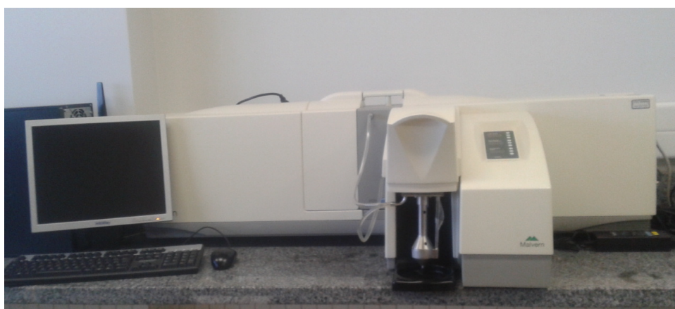
Figura 14. Analisador de partícula Malvern Mastersizer 2000 e o acessório para a introdução da amostras Hydro 2000.
