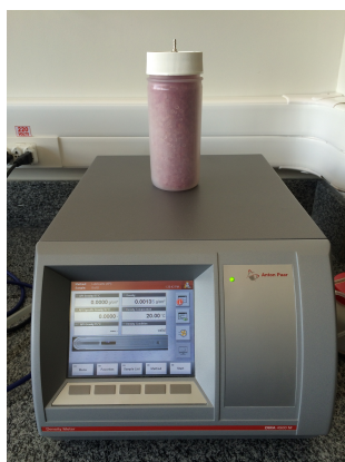
Figura 11. Densímetro DMA 4500M da Anton Paar
