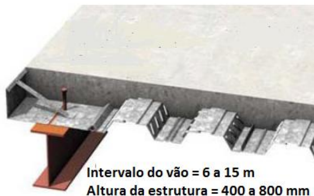
Viga mista – perfil de alma cheia e laje mista
