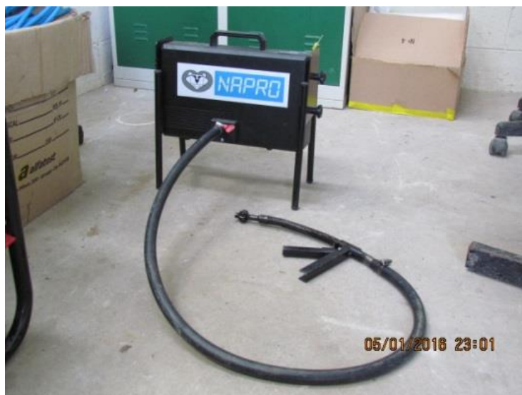
Figura10: Opacímetro utilizado na coleta dos dados
