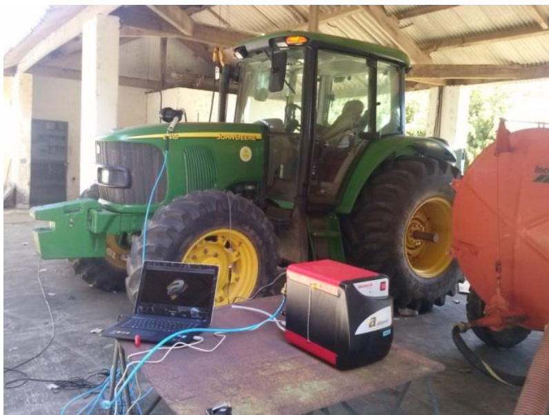
Figura 7: Utilização do equipamento analisador de gases
