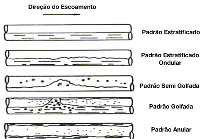
Figura 12 – Padrões de escoamento de gás úmido
