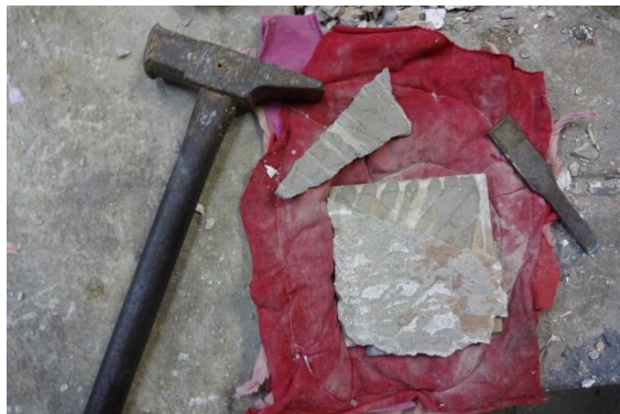
Figura 3.6 – Retirada da argamassa aderida à cerâmica no LEMAC
