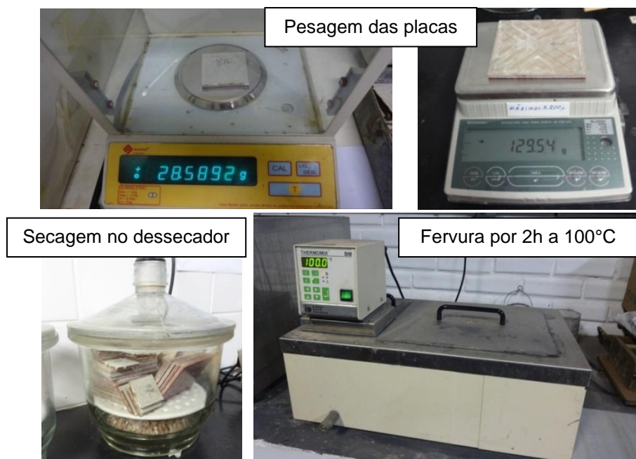
Figura 3.7 – Etapas do ensaio de absorção de água em placas cerâmicas
