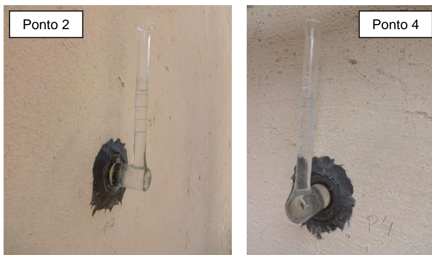
Figura 5.51 – Método do cachimbo em andamento em ARG2 nos pontos 2 e 4
