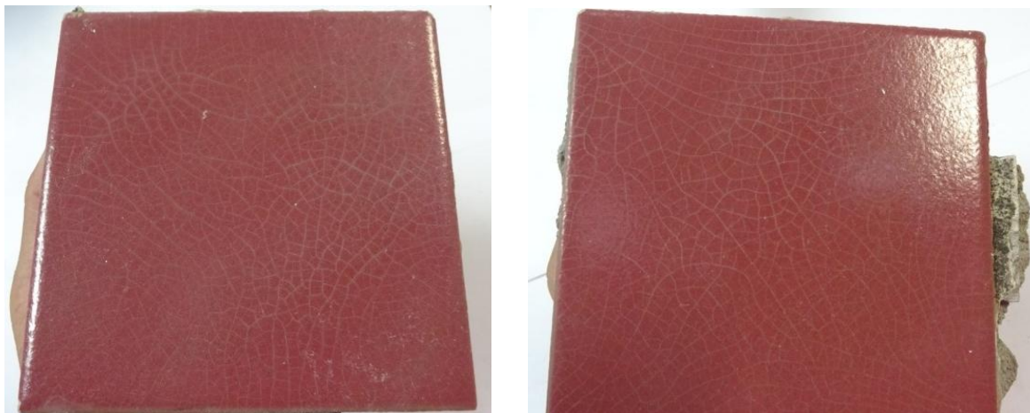
Figura 5.95 – Cerâmicas com gretamento – CER1
