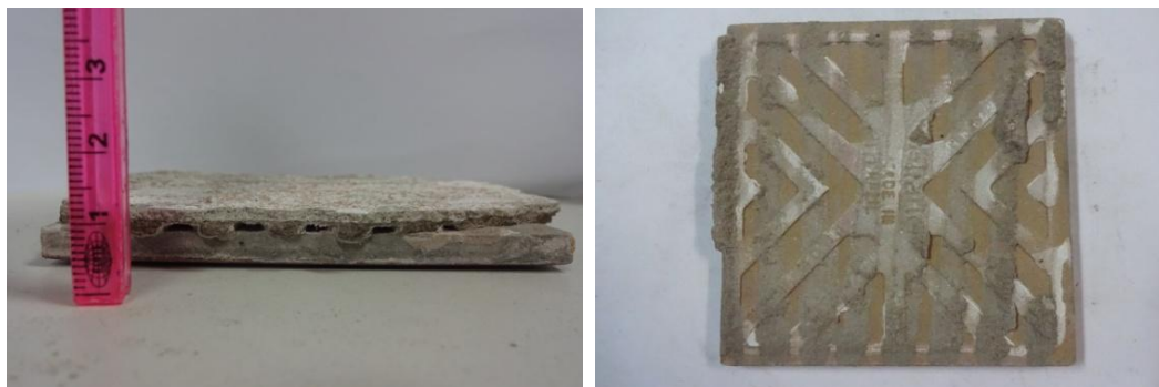
Figura 5.97 – Cerâmica com cordões de argamassa visíveis
