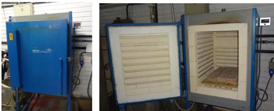
Figura 3.9 – Etapa de requieima das cerâmicas na mufla
