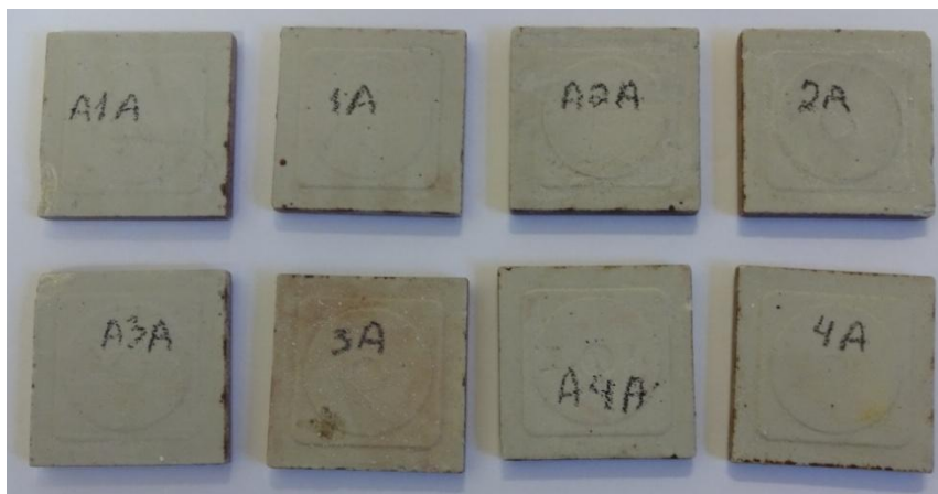
Figura 5.126 – Cerâmicas de CER2 após limpeza
