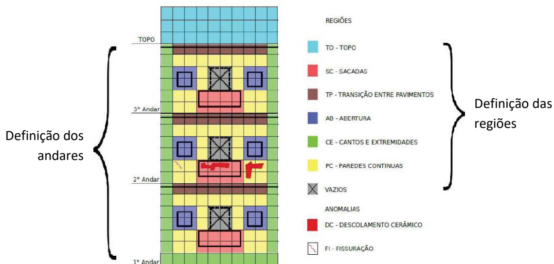
Figura 2.11 - Esquema ilustrativo da divisão dos andares e das regiões da fachada realizado por Souza (2016)
