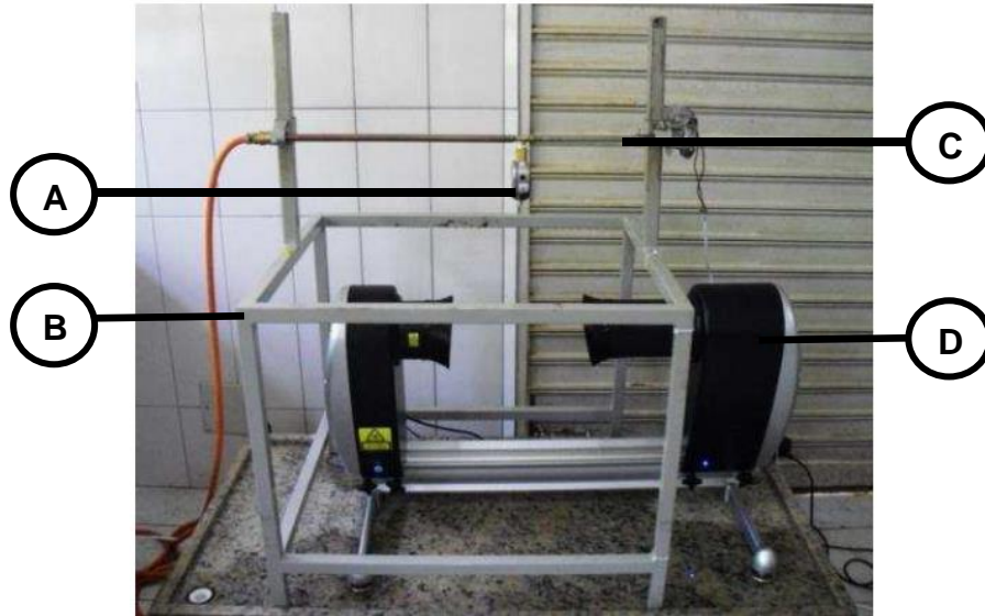
FIGURA 1. Estrutura para determinar o espectro de gotas. A. Ponta de pulverização hidráulica; B. Estrutura metálica; C. Estrutura simulando uma barra de pulverização; D. Analisador de partícula a laser.
