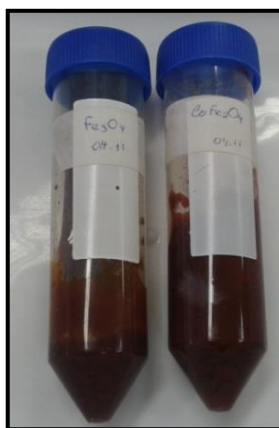
Figura 12 - Recipiente contendo precursor (sol-gel) das ferritas.
