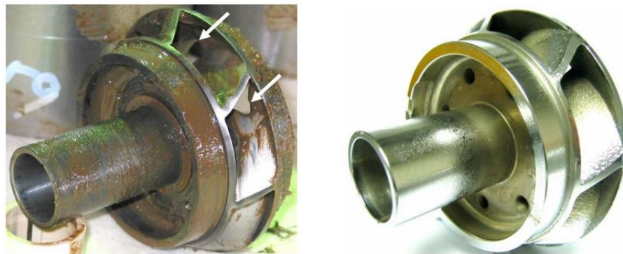
Figura 2 - Rotor de uma bomba centrífuga submersa erodida (esquerda) e nova (direita). Fonte: Jiang e Zreik (2007).
