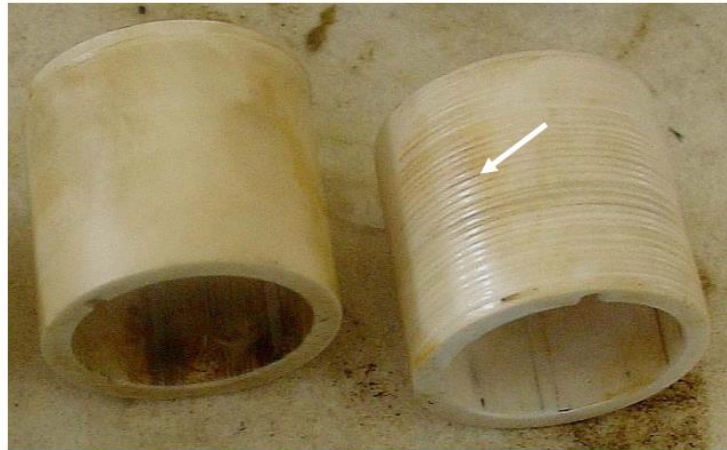
Figura 3 – Comparação de uma luva relativamente nova e uma desgastada. Fonte: Jiang e Zreik (2007).
