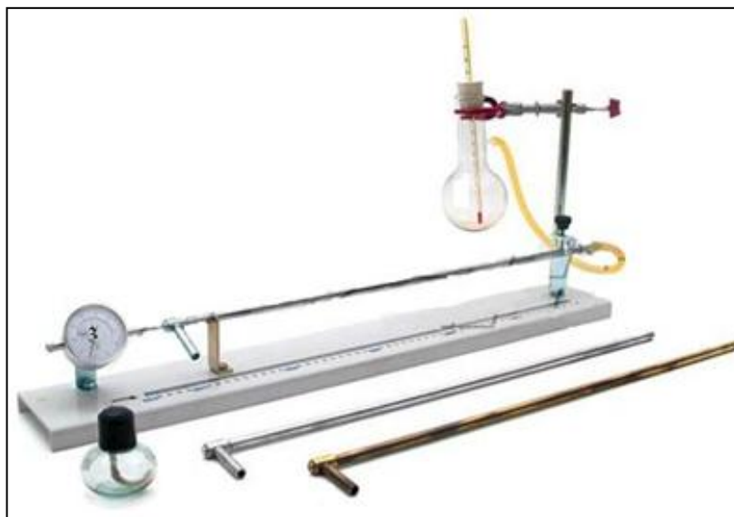
Figura 3.4: Experimento utilizado para a tomada de dados. Conhecido como Dilatômetro .
