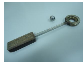
Figura 2.1: Equipamento utilizado para demonstrar a dilatação superficial.
