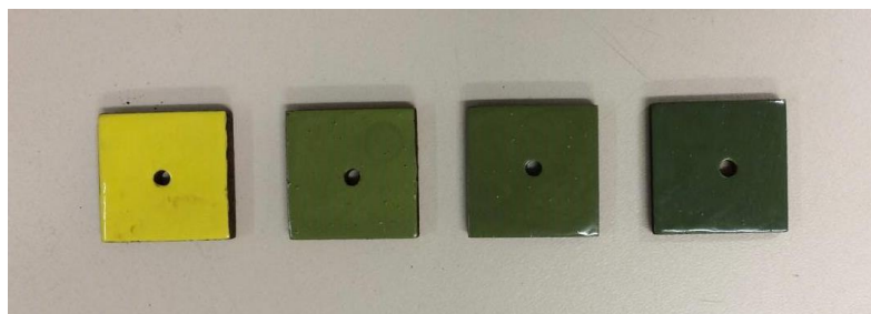
Figura 34 – Amostras de aço carbono revestida com tintas aditivadas (Fonte: Autor).
