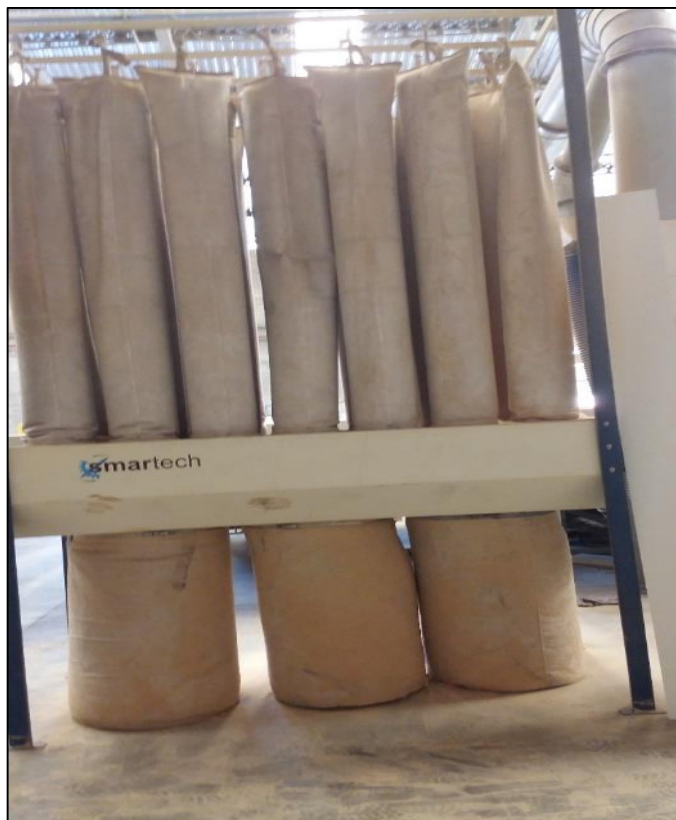
Fotografia 8 – Acondicionamento da serragem/pó de MDF na Empresa 2
