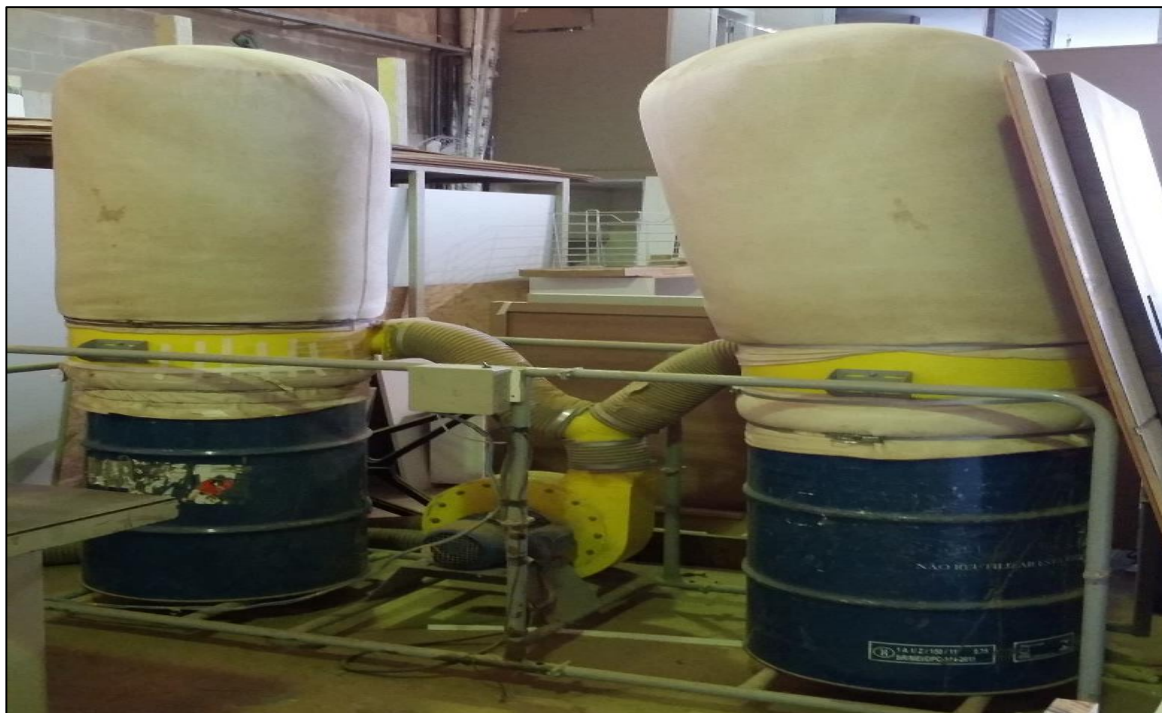
Fotografia 11 – Sistema de aspersão e latões para acondicionamento da serragem/pó de madeira e MDF na Empresa 4
