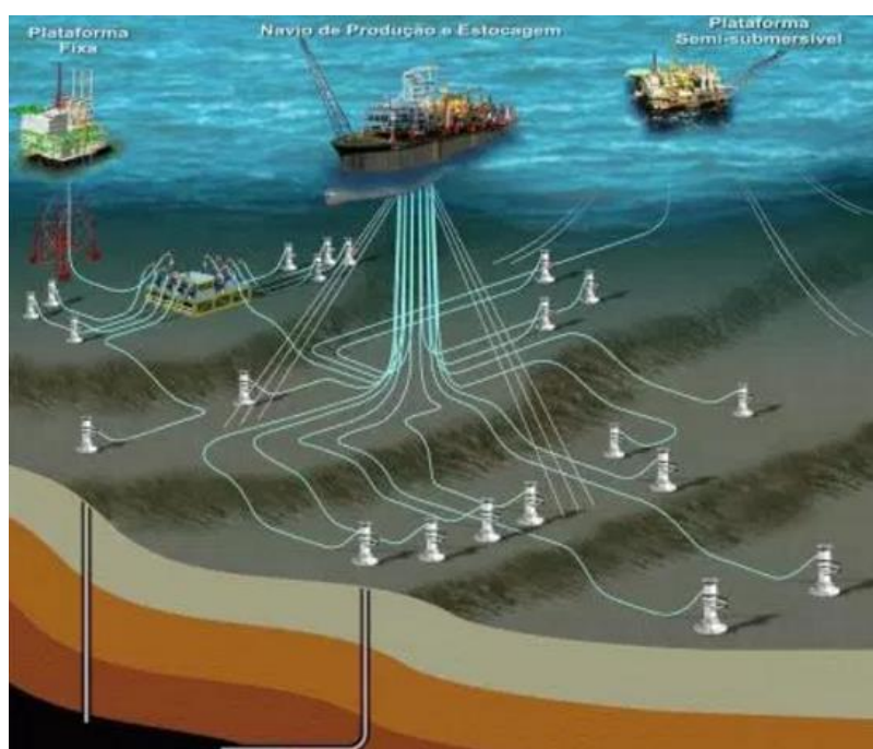
Figura 1. Representação do sistema de produção offshore de petróleo.
