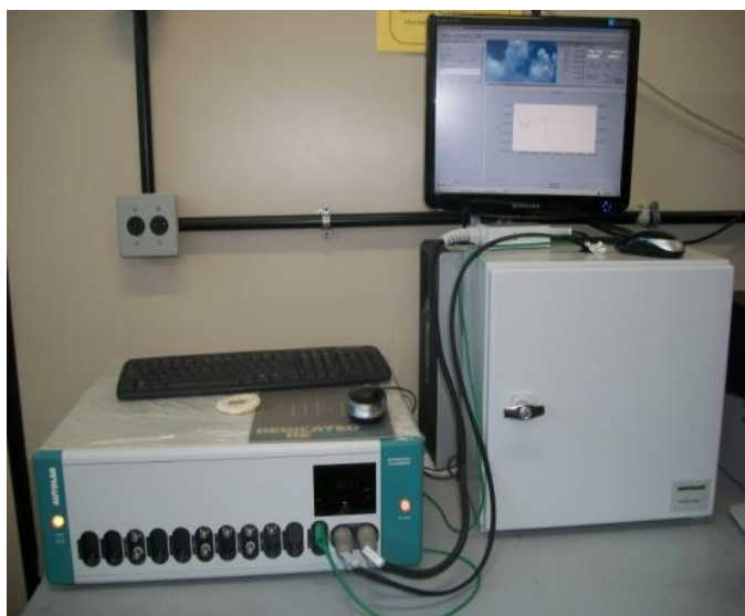
Figura 20 - Fotografia do potenciostato/galvanostato AUTOLAB modelo PGSTAT 100 (à esquerda). Abaixo do monitor está a gaiola de Faraday. Equipamento foi utilizado para medir a impedância das amostras de petróleo, derivados, misturas derivados/petróleos e emulsões A/O.
