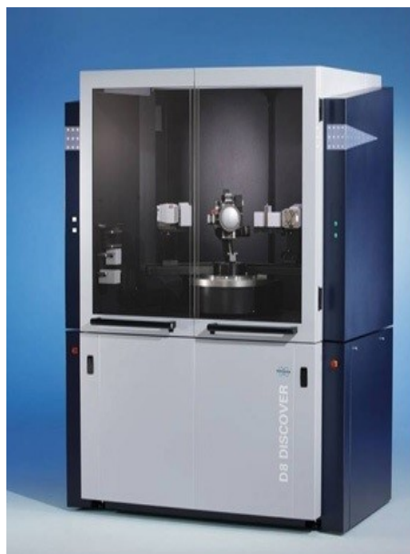
Figura 3.4: Difratorômetro de raios X da marca Bruker modelo Discover D8.
