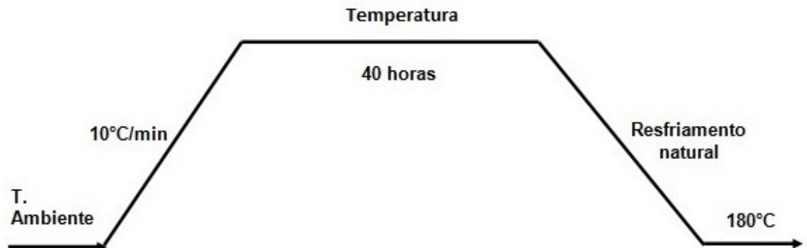
Figura 3.1: Primeiro tratamento térmico para as cerâmicas.
