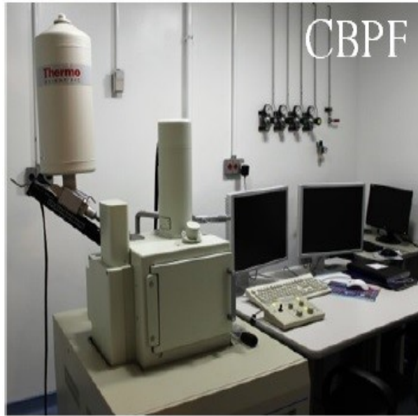
Figura 3.6: Equipamento de MEV da marca JEOL modelo JSM-6490LV do CBPF.
