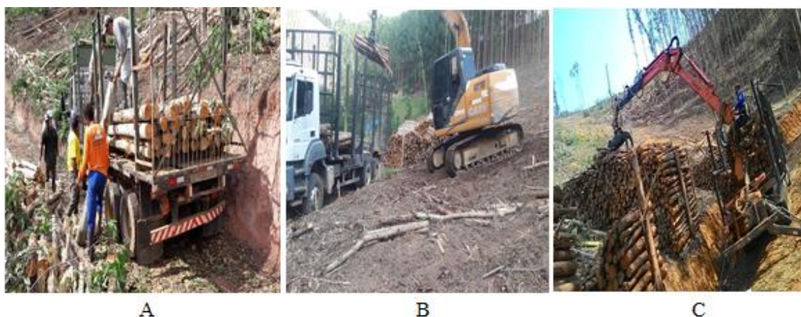
Figura 6 – Formas de carregamento avaliadas, manual (A), carregador florestal (B) e caminhão autocarregável (C)
