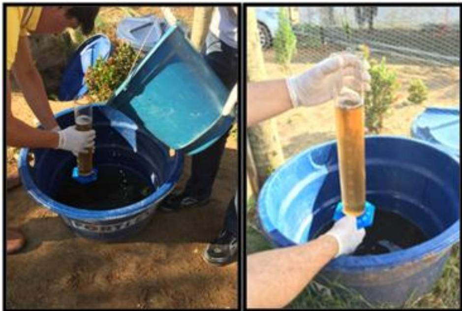
Figura 7 - Medição da vazão de saída e coleta de efluente para análise de qualidade da água residuária após passagem pelo sistema de tratamento.
