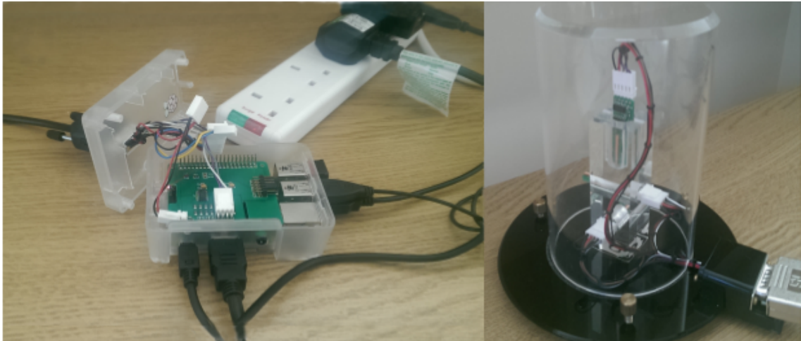
Figura 3.2: Magnetômetro desenvolvido pela BGS / Lancaster University Fonte: [Beggan and Marple 2016]
