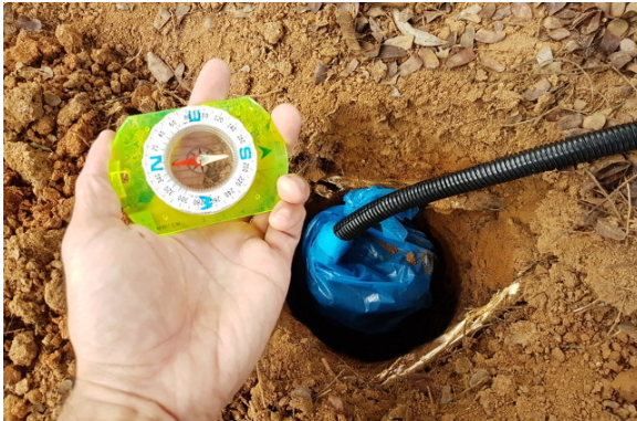
(6.17.1) Alinhamento horizontal feito com auxílio de uma bússola
