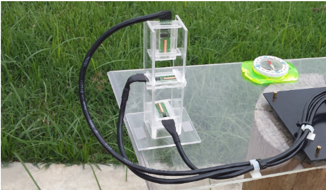
Figura 6.8: Torre de acrílico com a montagem dos 3 sensores FLC-100
