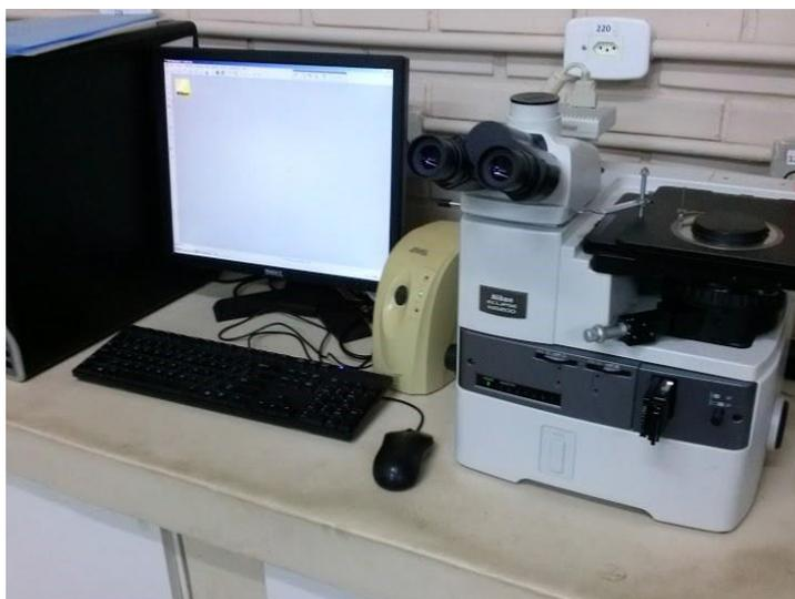
Figura 11 - Microscópio ótico Nikon Eclipse MA200 do laboratório TRICORRMAT-DEM-UFES.
