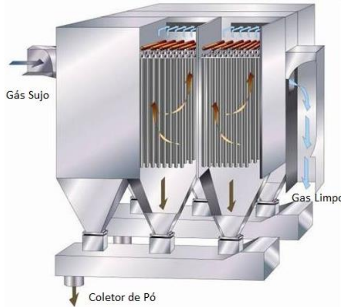
Figura 2.1 – Estrutura de um Filtro Manga. Fonte: INOVA (2017)
