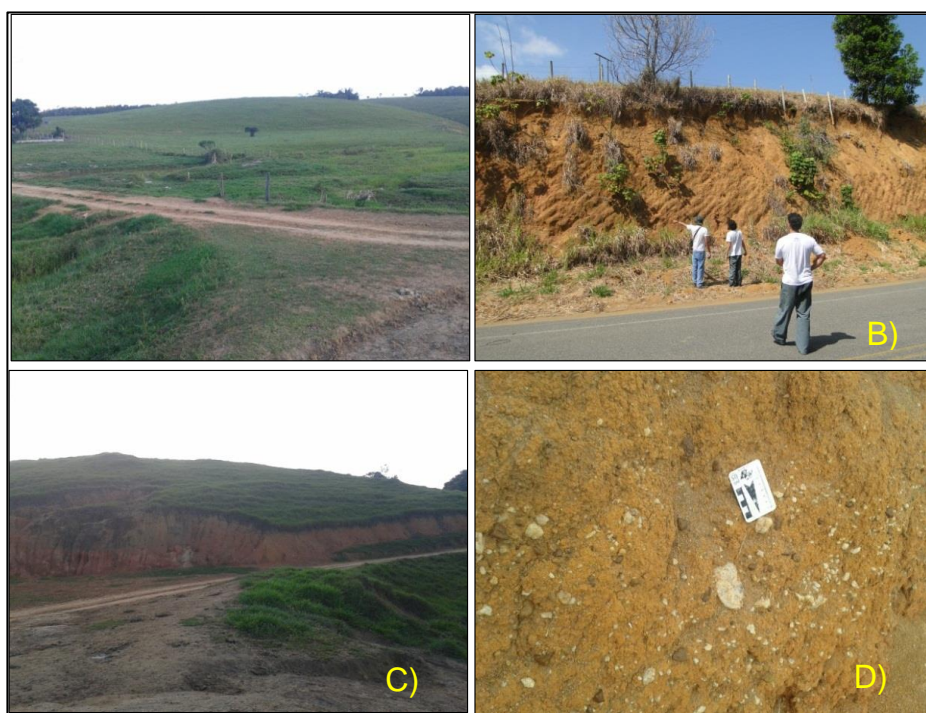
Figura 11: A) Relevo de ocorrência de Latossolo; B, C) Perfil de solo desenvolvido em Latossolos; D) Textura Argilosa e partículas de quartzo e concreções ferruginosas.
