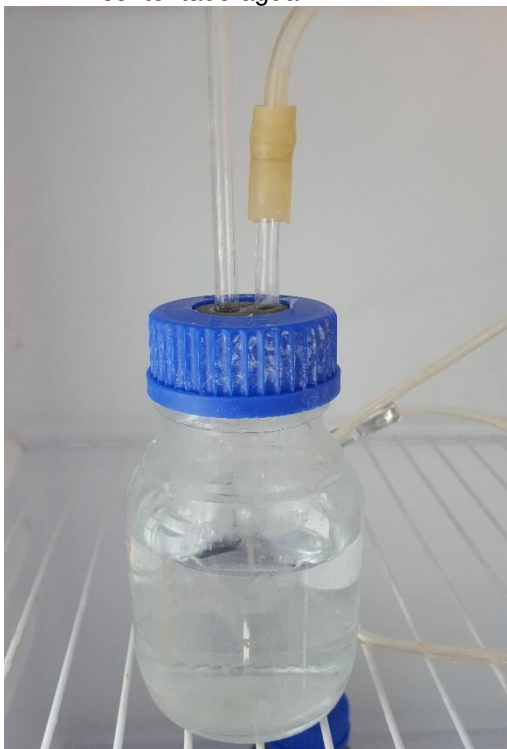
Figura 19: Detalhe da conexão das mangueiras de silicone no frasco contendo água.
