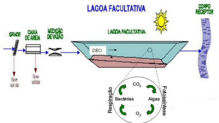
Figura 1: Esquema de funcionamento de uma lagoa facultativa.
