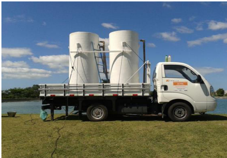
Figura 16: Polilag em operação na ETE Vale Encantado.
