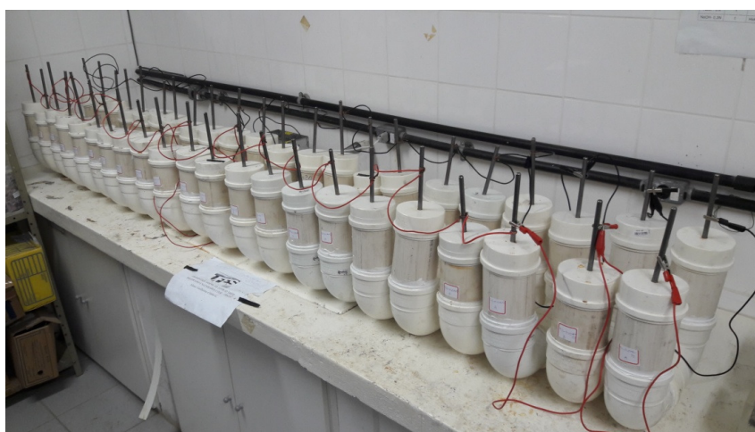
Figura 89. Execução de ensaio de migração de cloretos
