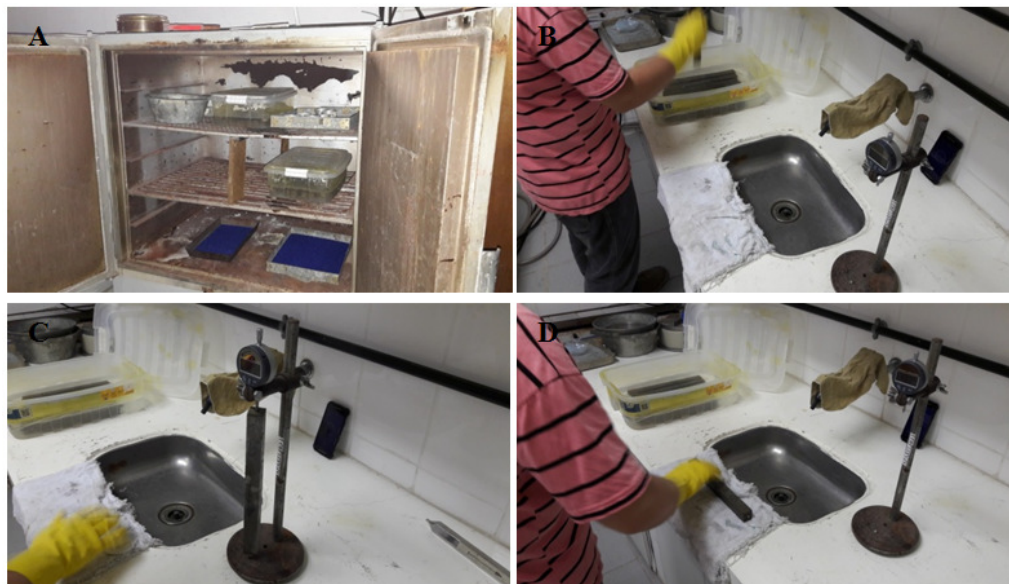
Figura 99. Processo de execução do ensaio de reação álcali-sílica (a: amostras em estufa; b: retirada de amostras de solução; c: processo de secagem e d: leitura da expansibilidade)
