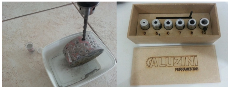
Figura 30. (a) Retirada de amostras em concreto (b) Limitador de profundidade necessário para obtenção das amostras em profundidades progressivas
