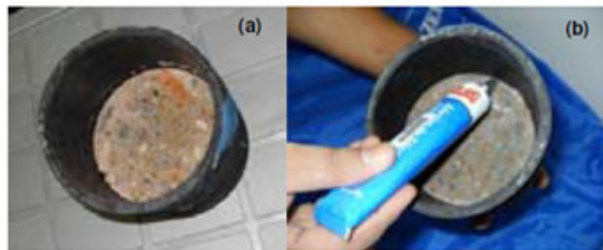
Figura 47. (a) Amostra em cinta de borracha (b) Procedimento de vedação com silicone
