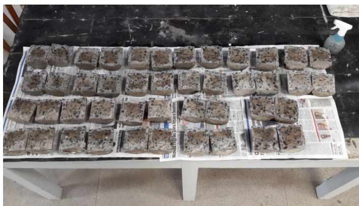
Figura 97. Amostras rompidas com aspersão de nitrato de prata
