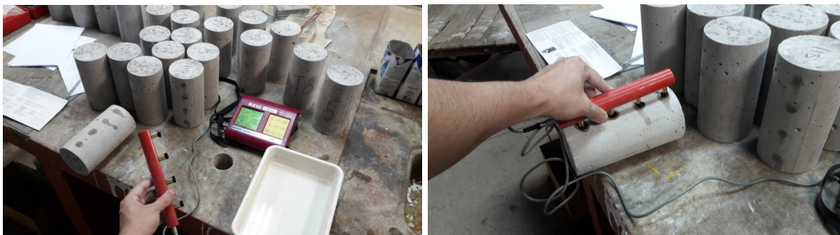
Figura 100. Ensaio de resistividade
