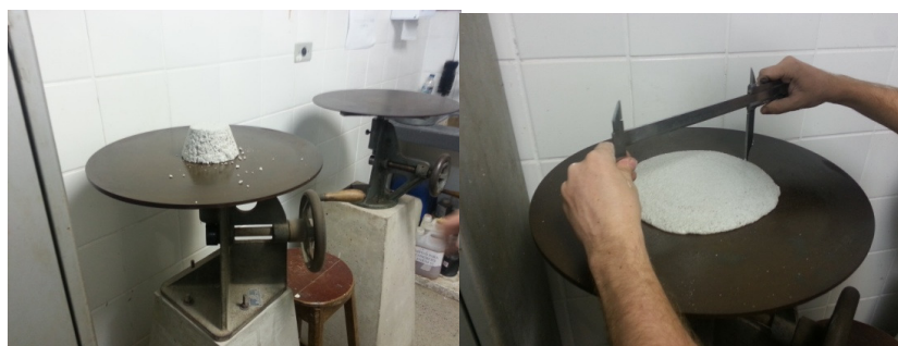
Figura 83. Execução de ensaio IAP cal
