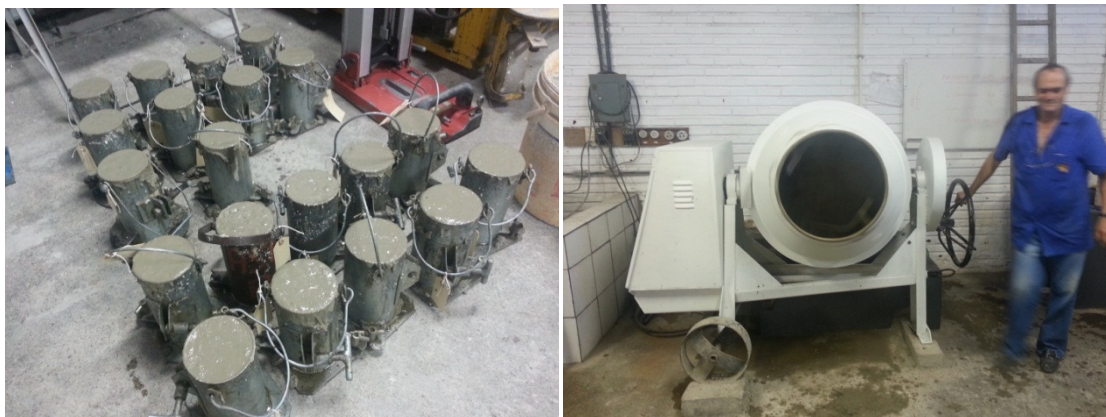
Figura 60. Moldagem de corpos de prova para o ensaio de dosagem IPT
