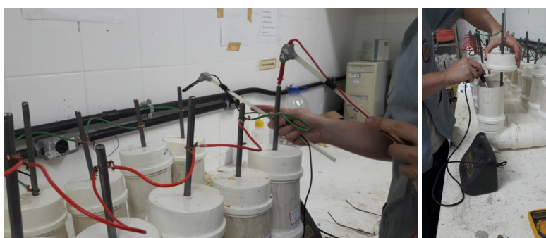
Figura 90. Leituras do ensaio de migração de cloretos
