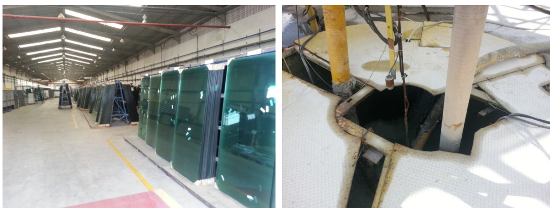
Figura 71. Panos de vidros que passam por processo de lapidação e detalhe de ponto de captação de água residual
