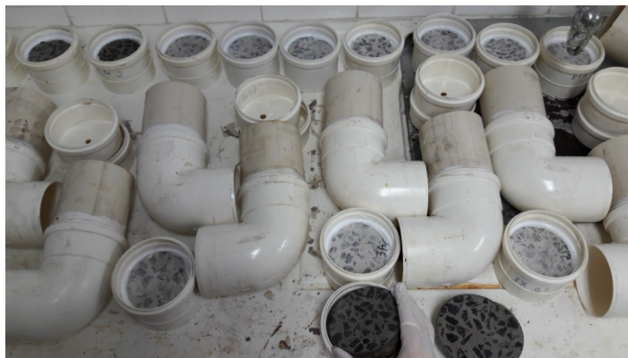
Figura 88. Montagem do aparato de migração de cloretos
