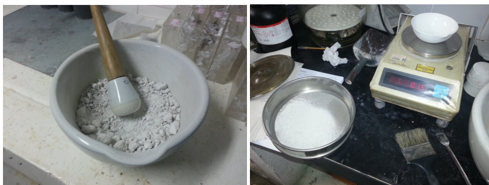
Figura 78. Destorroamento do resíduo de vidro - detalhe
