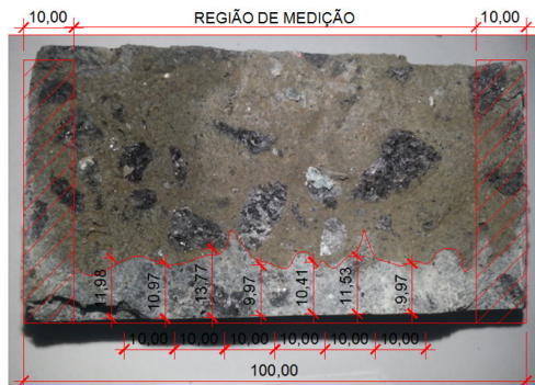
Figura 46. Sistema de medição em amostra de concreto, conforme NT Build
