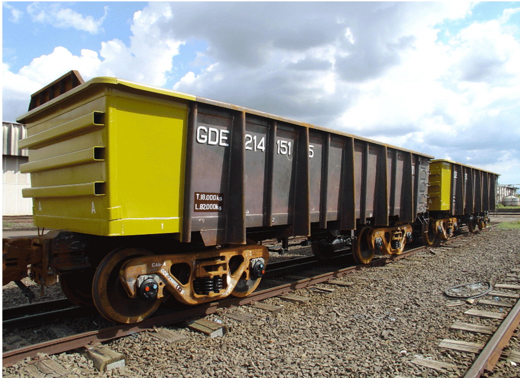
Figura 6 - Vagão Gondola do tipo GDU
