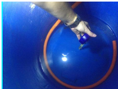
Figura 23 – Aferição da Altura de lamina d'água com base no centro do galão
