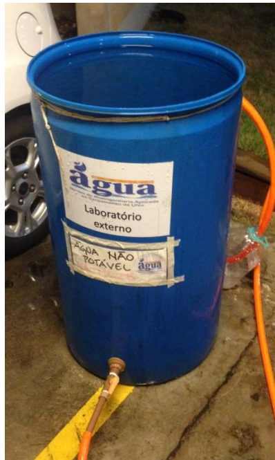
Figura 22 – Galão para medição de vazão através do método volumétrico
