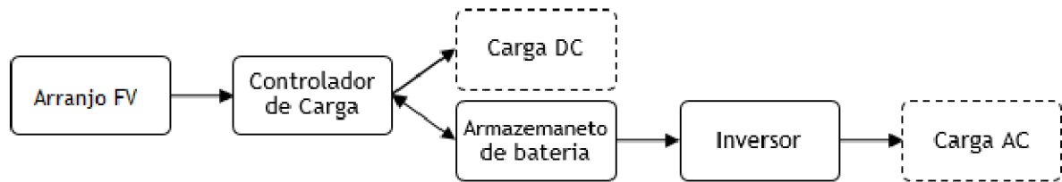
Figura 7 - Diagrama esquemático de uma aplicação de um sistema FV isolado
