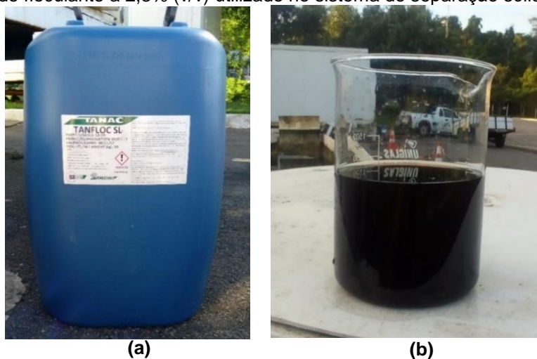
Figura 15 – (a) Reservatório do floculante a base de tanino modificado de nome comercial TANAC® a 25% (v/v). (b) Solução de floculante a 2,3% (v/v) utilizado no sistema de separação sólido-líquido
