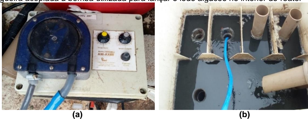
Figura 16 – (a) Bomba peristáltica utilizada para bombear o lodo algáceo para o reator UASB. (b) Mangueira acoplada à bomba utilizada para lançar o lodo algáceo no interior do reator
