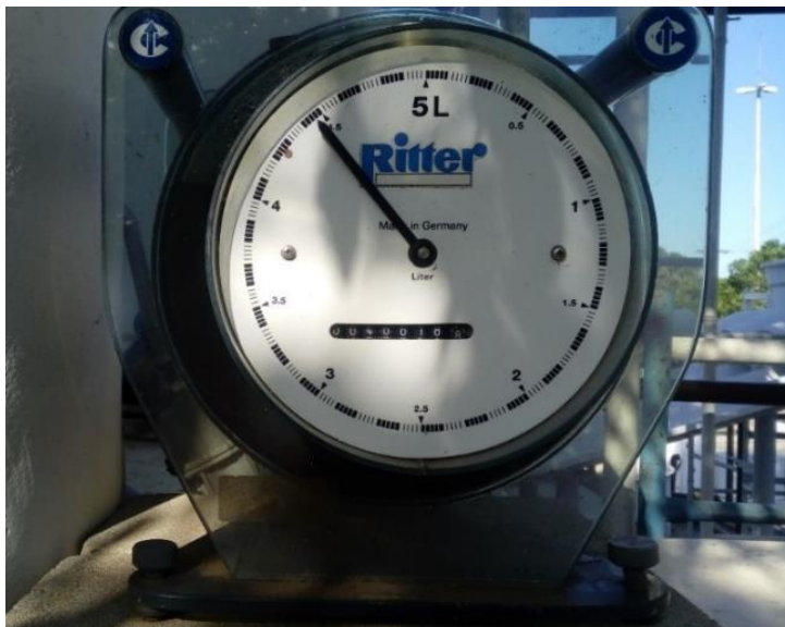
Figura 21 – Medidor de biogás Ritter (modelo TG5) utilizado para mensuração da produção volumétrica diária de biogás
