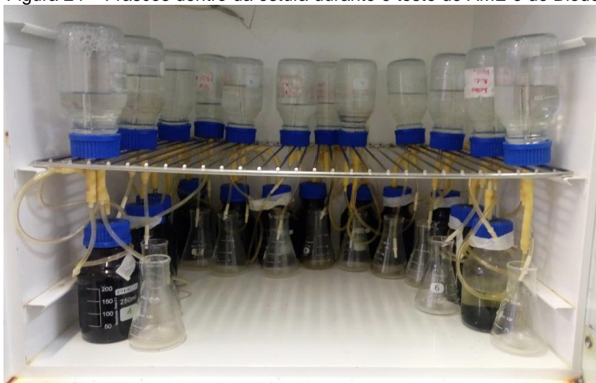
Figura 24 – Frascos dentro da estufa durante o teste de AME e de Biodegradabilidade
