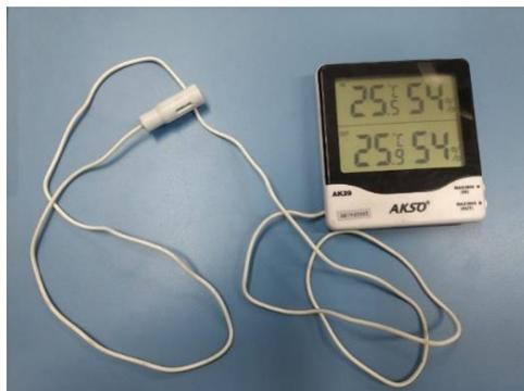
Figura 17: Termo-higrômetro utilizado nas medidas de temperatura e umidade relativa do ar
