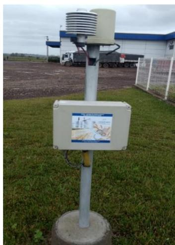
Figura 13: Estação meteorológica
