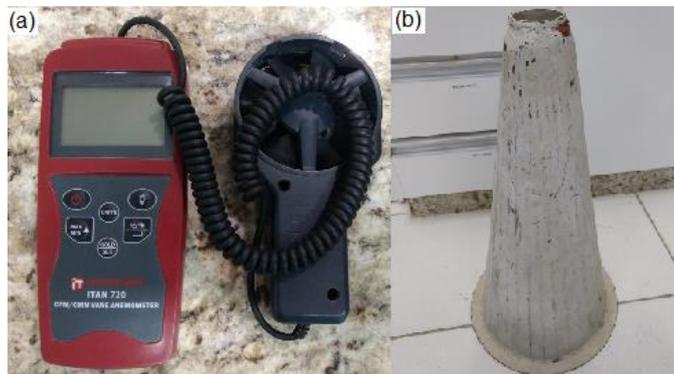
Figura 19: Anemômetro de hélice (a) e campânula de medição (b)
