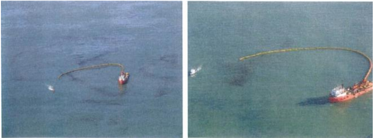
Figura 8 – Cerco da mancha de óleo com barreira do incidente ocorrido em 21/06/2011
