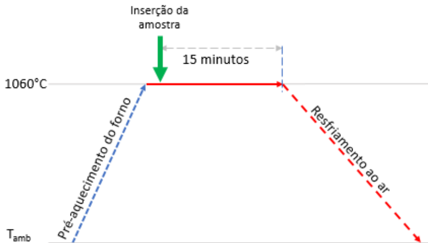
Figura 24: Resumo do tratamento térmico ao qual a junção foi submetida - Método Flash.
