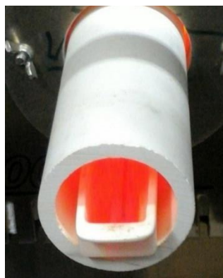
Figura 22: Amostra sendo inserida no forno para tratamento térmico.
