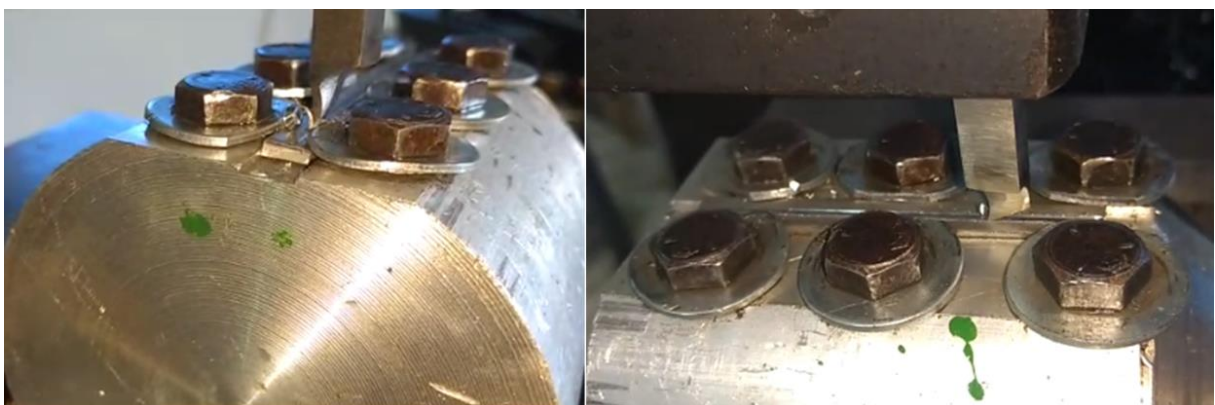
Figura 20: Ilustração da confecção do canal na base de AISI 304L [48]
