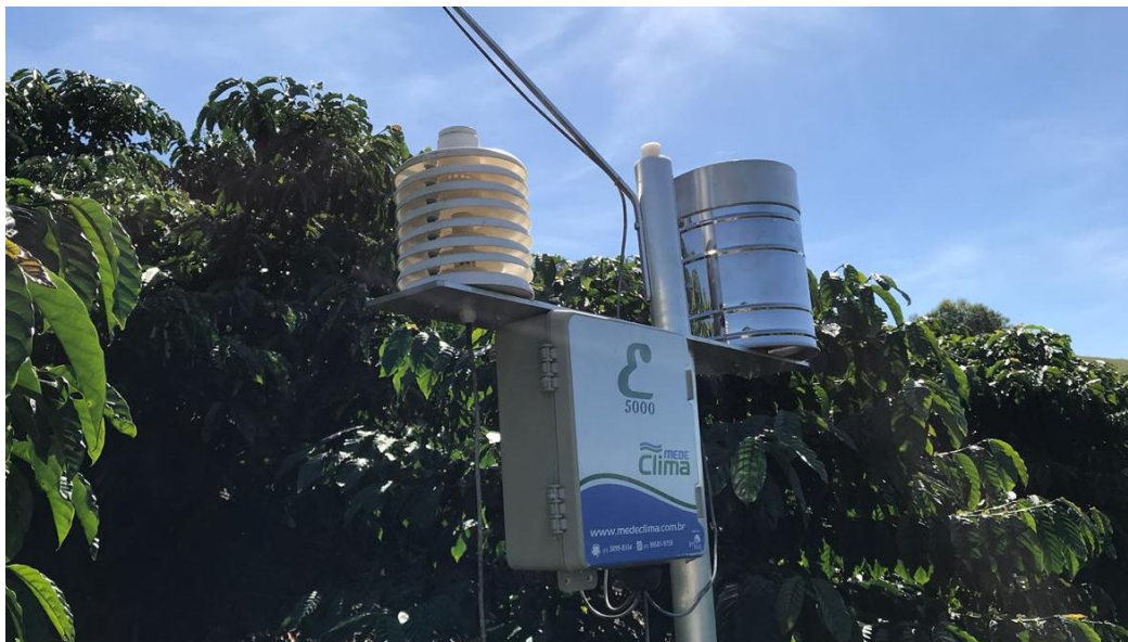
Figura 1. Estação Meteorológica Automática IRRIPPLUS Equipamentos – Modelo E5000 utilizada nas lavouras do Ambiente 1. (Fonte: O autor).
