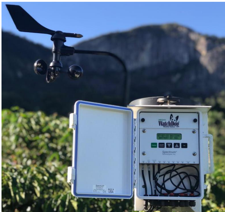
Figura 2. Estação Meteorológica Automática Spectrum Technologies Inc. - Modelo WATCHDOG 2000 Series utilizada nas lavouras do Ambiente 2. (Fonte: O autor).
