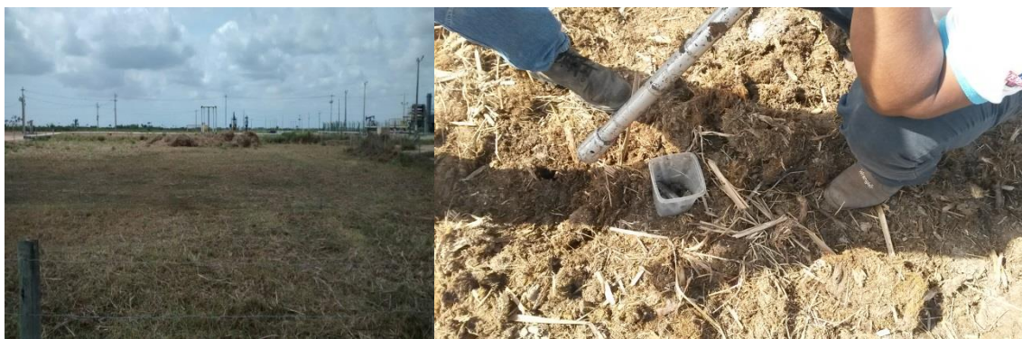
Figura 1. Limpeza da área para instalação dos experimentos (A) e amostragem de solo na camada de 0,0-0,2 m e 0,2-0,4 m para caracterização inicial (B).
