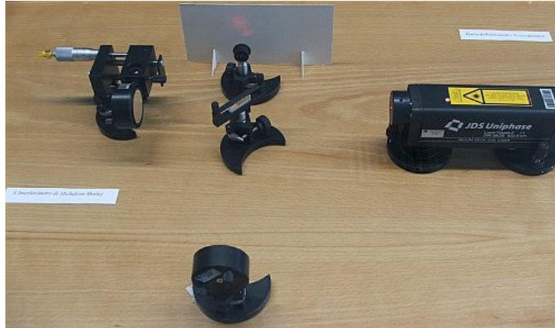
Figura 39: Aparato experimental do interferômetro de Michelson-Morley.
