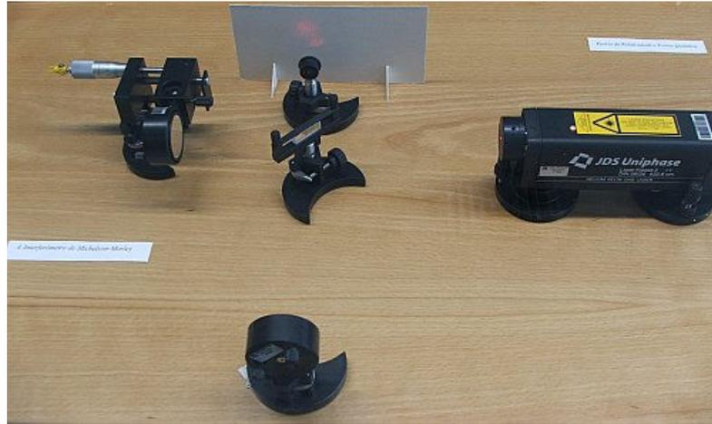
Figura 20: Aparato experimental do interferômetro de Michelson-Morley.
