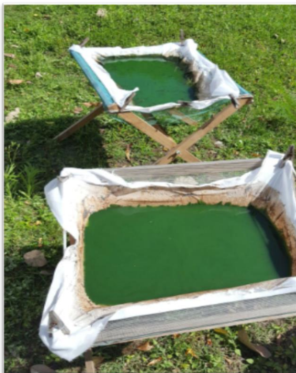
Figura 12: Sistema de telas filtrantes utilizado para concentração da biomassa.
