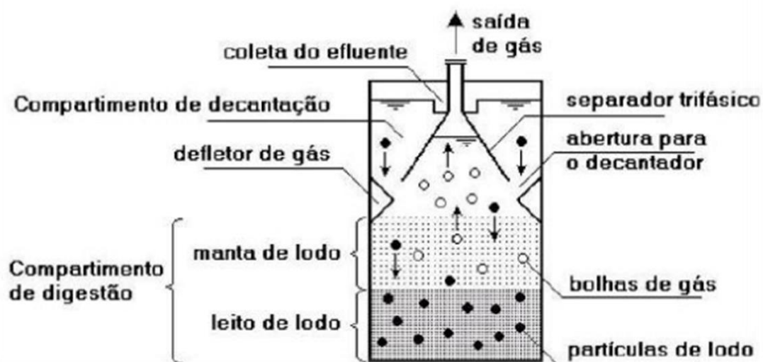
Figura 4: Funcionamento e compartimentos do reator UASB.
