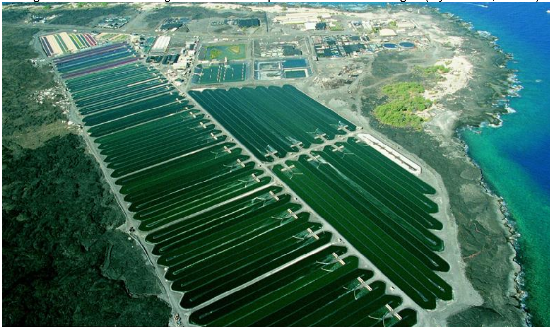
Figura 3: Sistemas de lagoas de alta taxa para cultivo de microalgas (Cyanotech, Hawaii).
