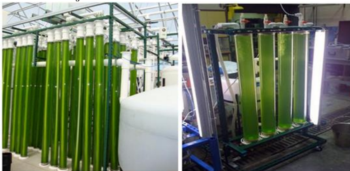
Figura 1: Sistemas de fotobiorreatores fechados tubulares.
