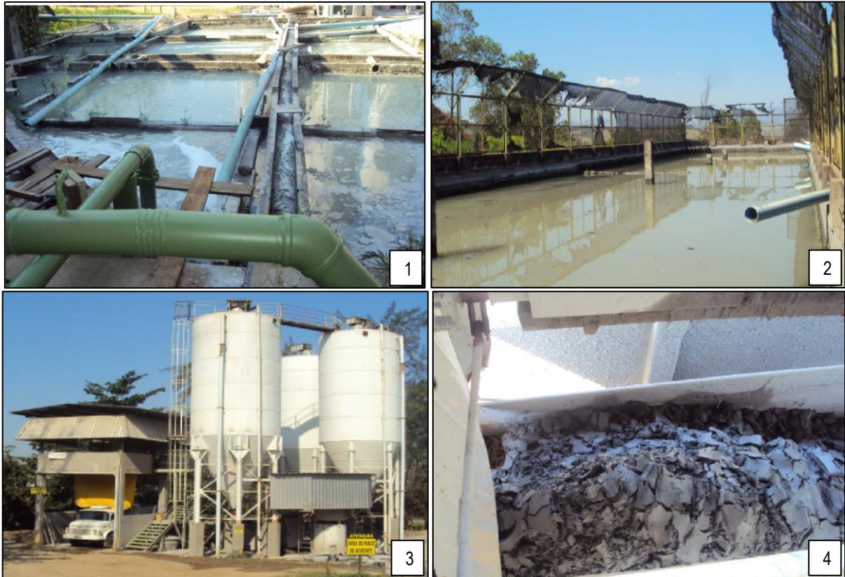
Figura 7 – Processo de coleta, circulação e armazenamento da água para reuso da EMG01.
