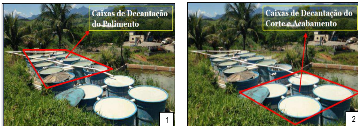
Figura 15 – Demonstrativo das caixas do sistema de decantação do polimento e do corte e acabamento.
