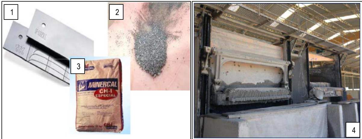
Figura 12 – Demonstrativo das lâminas de aço, granalha de aço e cal e dos teares multilâminas em processo de serragem.
