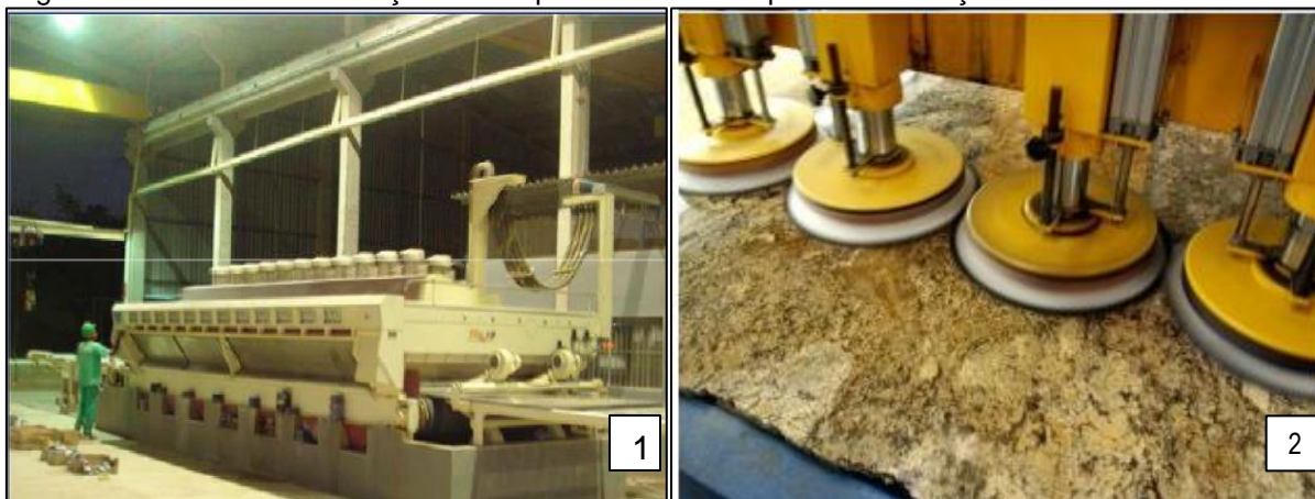
Figura 13 – Demonstração da politriz de chapas - cabeçotes em funcionamento.
