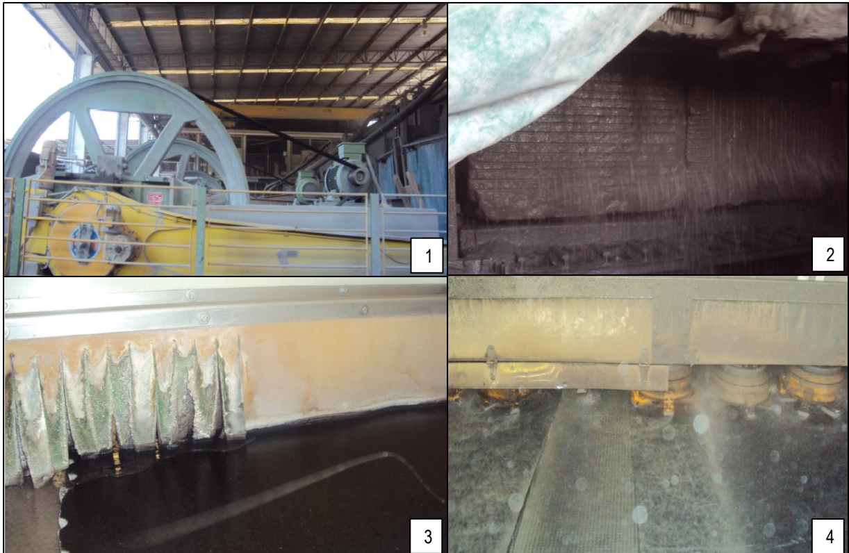
Figura 8– Demonstração um tear convencional nos processos de serragem de blocos e polimento de chapa da EMG01.
