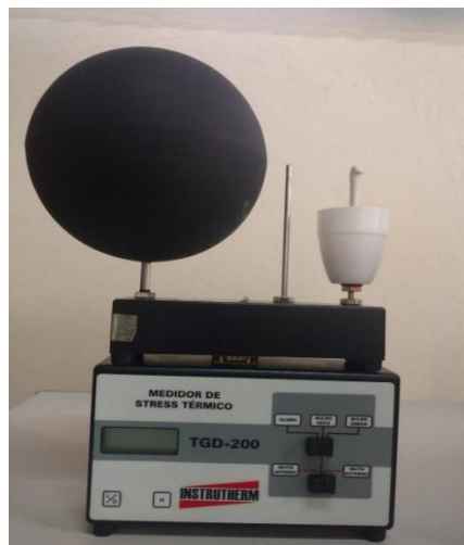
Figura 5 – Índice de Bulbo Úmido Termômetro de Globo – IBUTG (Fonte: o autor).
