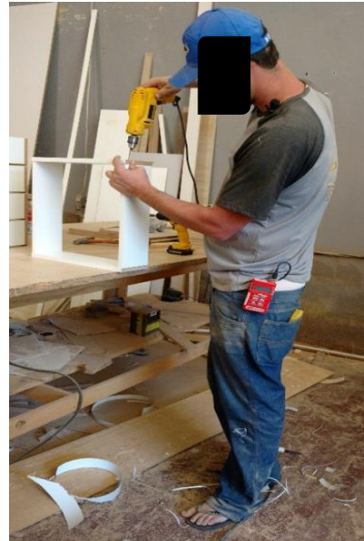
Figura 8 – Dosímetro de ruído acoplado ao trabalhador (Fonte: o autor).
