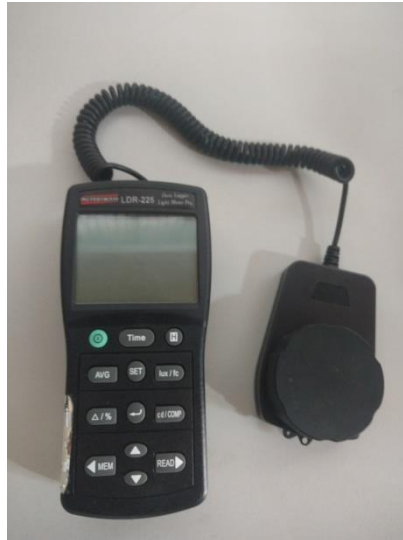
Figura 6 – Luxímetro digital portátil (Fonte: o autor).
